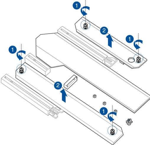
3. Installez votre module M.2 dans le slot M.2. Les étapes d'installation peuvent différer selon la longueur du module M.2, référez-vous aux procédures d'installation adaptées aux différents types de lecteurs M.2 :
